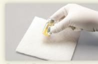
Figure 2 : Taper le flacon fermement pour mélanger.
